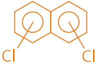
Figura 24. Estructura química dels naftalens policlorats (PCN)
